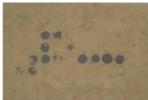
รูปที่ 5 การทดสอบการสร้างก๊าซไฮโดรเจนจากจุลินทรีย์สังเคราะห์แสงในสถานะปราศจากออกซิเจน แสดงการเปลี่ยนสีของสารผสมสังเคราะห์ทดสอบจากสีน้ำตาลอ่อนเป็นสีเทาดำ
