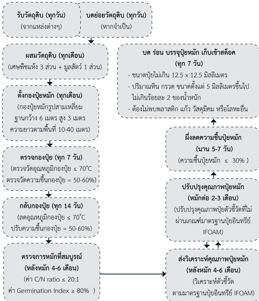
ภาพที่ 1 แผนภาพแสดงกระบวนการผลิตปุ๋ยหมักจากวัสดุอินทรีย์ชนิดแห้ง
