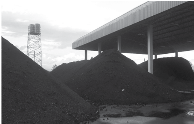
ภาพที่ 4 ตั้งกองหมักปุ๋ยเป็นแถวรูปทรงสามเหลี่ยมฐานกว้าง 3-6 เมตร สูง 1.5-2 เมตร ความยาวกองปุ๋ยตามขนาดพื้นที่โรงงาน
