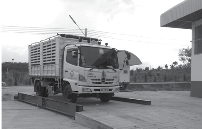
ภาพที่ 3 เครื่องชั่งวัตถุดิบขนาดใหญ่ (เครื่องชั่งรถบรรทุก) ขนาดพิกัดกำลังการชั่งในระดับ 40-100 ตัน
