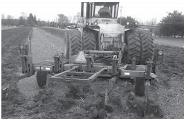
ภาพที่ 7 ตัวอย่างวิธีการทำลายชั้นดานในหน้าตัดดิน โดยทำการไถทำลายชั้นดินดาน ที่มา : www.thaitapiocastarch.org
